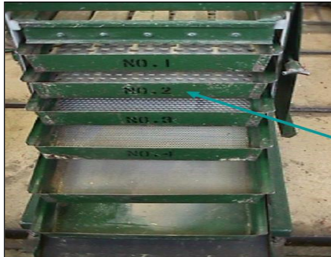
شکل ۱-۱. نمایی از الک های انجمن مهندسين کشاورزي امريکا با پنج الک و یک صفحه انتهایی. اندازه اسمی منافذ به ترتیب از الک بالایی ۱۹، 12/7 ، 6/3 ، 3/93 و 1/17 میلی متر است.
