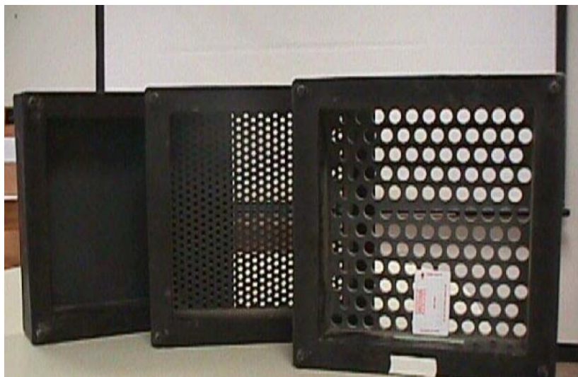
شکل ۱-۳. نمایی از الک های قدیم ایالت پنسیلوانیای امریکا و یک صفحه انتهایی. الک درشت دارای منفذ ۱۹ و الک ریز دارای منفذ ۸ میلی متری است.
