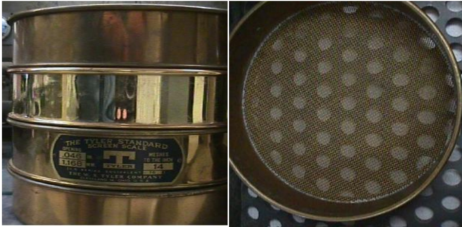
شکل ۱-۵. نمایی از الک های جدید ایالت پنسیلوانیای امریکا و یک صفحه انتهایی برای اندازه گیری اندازه ذرات ریز و مواد دانه ای. قطر منفذ الک بالای ۱۹، الک میانی ۸ و الک پایینی ۱/۱۸ میلی متر می باشد.
