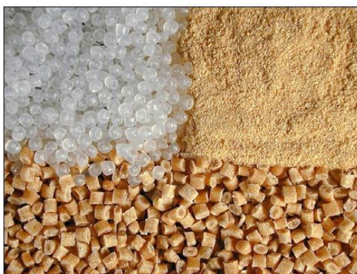
شکل ۱-۱: نمونه‌ای از گرانول تولید شده از ذرات چوب و پلی‌اتیلن [۳]
