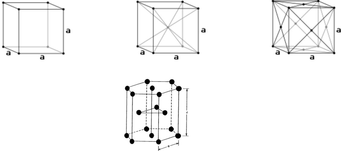
نمودار (۱-۱). به ترتیب از چپ به راست: ساختار مکعبی ساده، ساختار مکعبی مرکز حجمی، ساختار مکعبی مرکز سطحی و ساختار شش گوشه تنگ پکیده.
