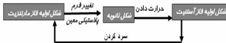
شکل ۲-۱ سیکل حرارتی مکانیکی توصیف کننده پدیده حافظه داری شکلی [۳]
