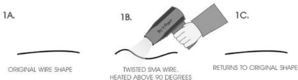
شکل ۳-۱ نمایی از تأثیر گرما در تغییر شکل اولیه سیم‌های دارای حافظه شکلی [۷]
