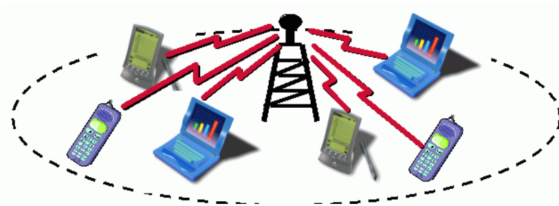
شکل ۱-۱: مثالی از یک شبکه دارای زیر ساخت.
