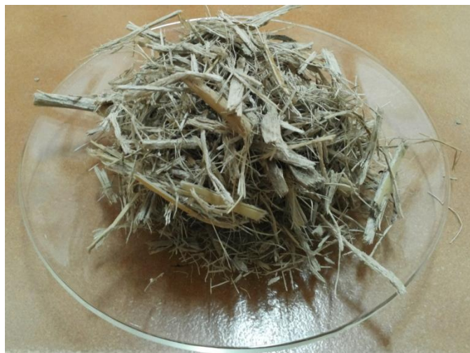
شکل ۱-۱ باگاس مغززدایی شده (تهیه شده از کارخانه کاغذ پارس)
