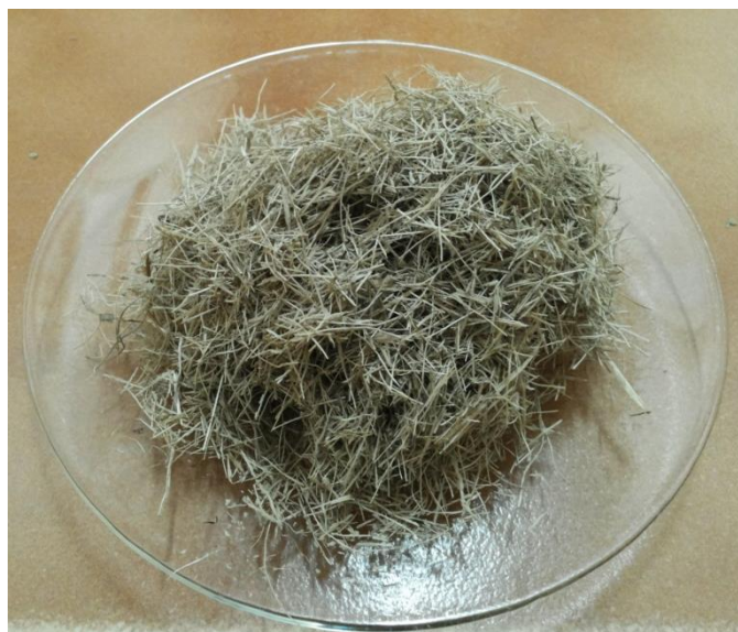
شکل ۱-۲ نمونه مغز باگاس (تهیه شده از کارخانه کاغذ پارس)
