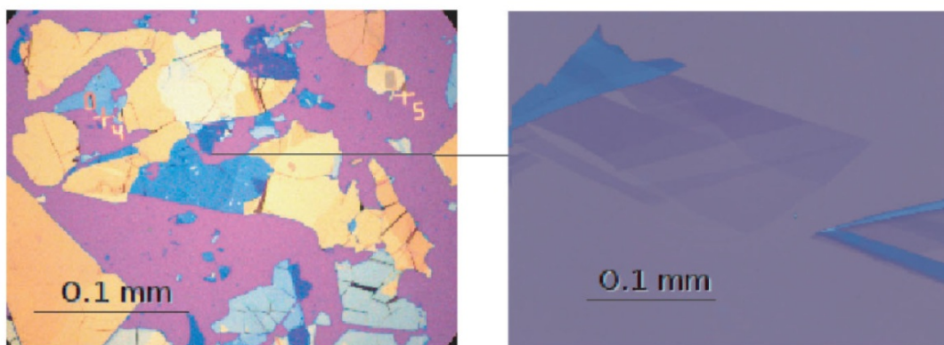
شکل 9-1 گرافن در زیر میکروسکوپ نوری. چپ: گرافن یک یا چند لایه روی اکسید سیلیکن که کاملاً در زیر میکروسکوپ نوری متفاوت هستند. راست: گرافن تک لایه و چند لایه که مشخص است [29].
