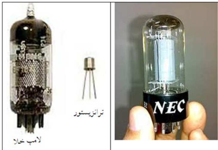
شکل (۱-۱): دو نمونه از لامپهای خلا و مقایسه ظاهری آن با ترانزیستور.
