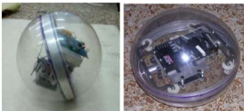
۲-۱ ربات کروی با قابلیت حرکتی بکمک تغییر مرکز جرم
