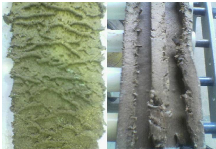
شکل ۱-۱: پدیده شکست مذاب در اکستروژن پروفیل‌های کامپوزیت چوب-پلاستیک [۱۸]
