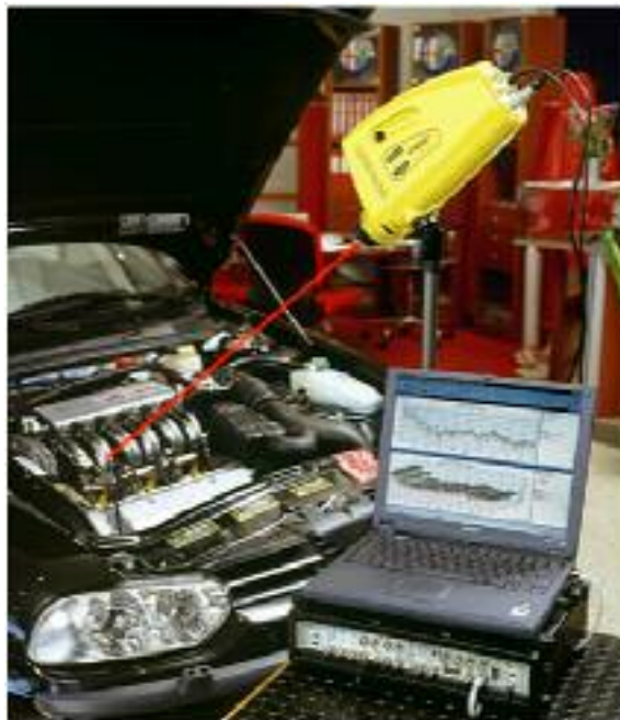
شکل ۱-۲- آزمون مودال عملیاتی بر روی موتور یک خودرو
