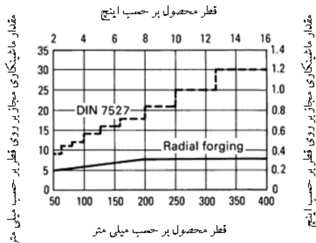
شکل ۱-۱۱: مقدار ماشینکاری مجاز در آهنگری شعاعی در قطرهای مختلف [۱].
