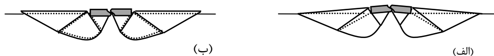
شکل ۲-۳ مکانیزم گسیختگی Hill (1950)، (الف) شکست ناشی از خمش و (ب) شکست برشی ناشی از دو نیم شدن
