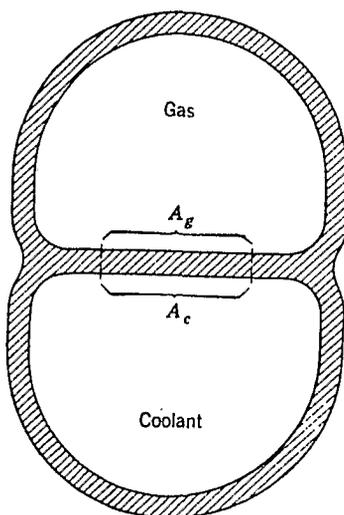
شکل (۱-۱): تصویری از تبادل حرارت بین دو سیال با دیوار مشترک (سیال در امتداد عمودی حرکت می کند)
