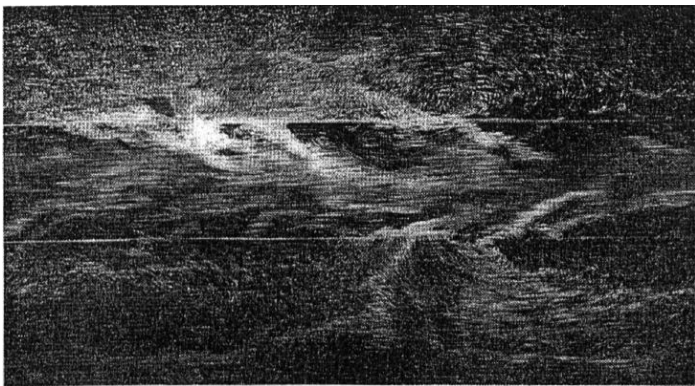
شکل ۳-۲- گردابه های مشاهده شده در محل تقاطع کانال اصلی و سیلابدشتها (Sellin, 1964)
