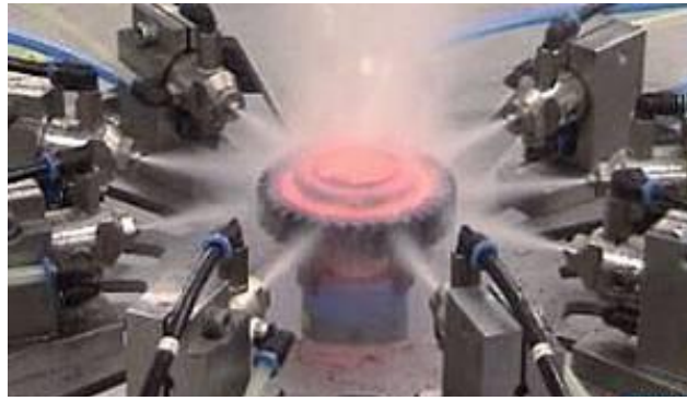
شکل 1-2: سیستم سرمایش قطعات ماشین کاری شده
