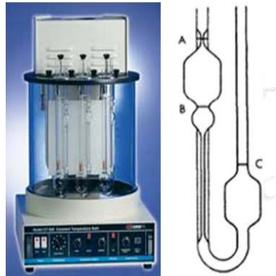
شکل (۱-۱) ویسکومتر لوله موئین
