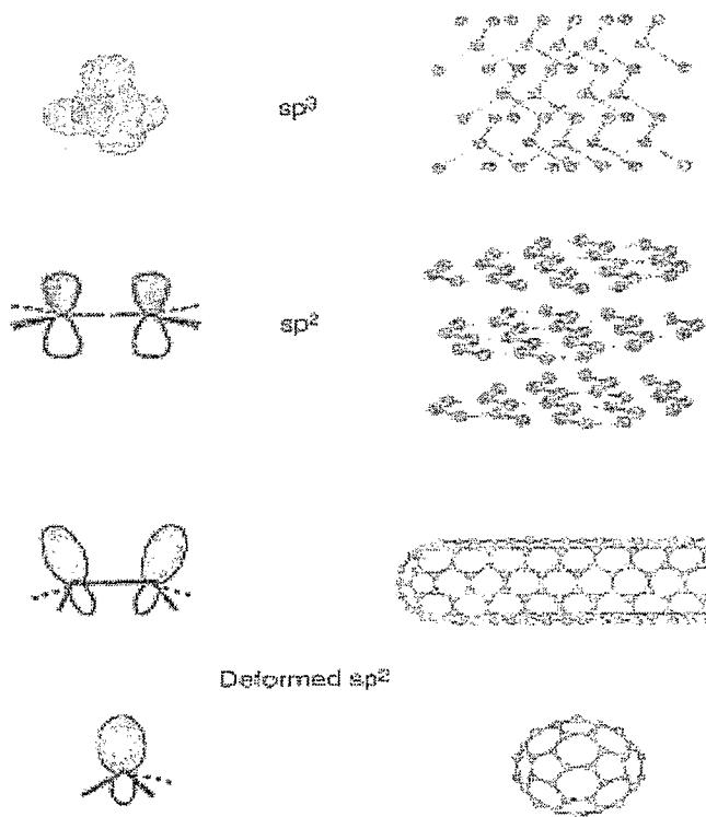
شکل (۱-۱). ساختارهای پیوندی الماس، گرافیت، لوله های نانویی، و فلورن ها؛ زمانی که یک صفحه گرافیتی می چرخد و یک لوله نانویی را ایجاد می کند، اربیتال هیبریدی  $sp^2$  به دلیل باز-هیبریداسیون  $sp^2$  به سمت اربیتال  $sp^3$  یا ترکیب پیوندهای  $\pi - \sigma$ ، تغییر شکل می دهد. این شکل ساختاری باز-هیبریداسیون، همراه با تحديد الکترون  $\pi$ ، به لوله های نانویی خواص الکترونیکی، مکانیکی، شیمیایی، گرمایی، مغناطیسی، و اپتیکی خارق العاده و یگانه ای داده است [۸].
