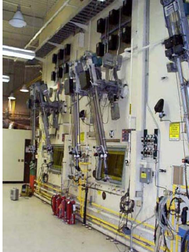
شکل ۱-۱ نمای خارجی یک مجموعه اتاقک های سلول داغ (Hotcell) را نشان می دهد.
