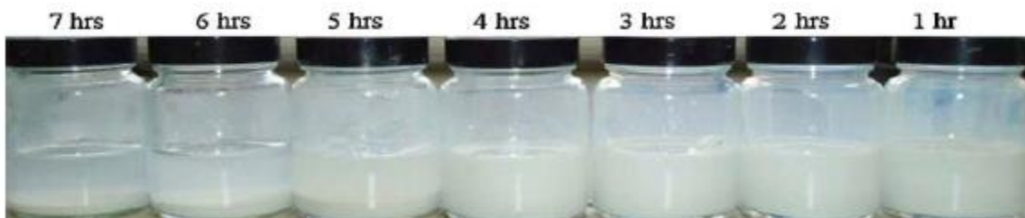
شکل (۳-۱): تغییرات پایداری نانوذره Al_2O_3 (بدون پایدارکننده) در طول زمان (Shen, B., 2006)
