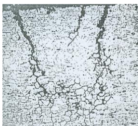
شکل ۱-۵- ترک خوردگی خوردگی تنش
