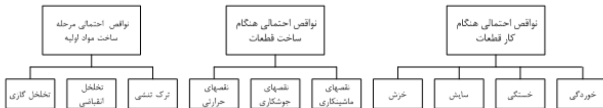
شکل ۱-۱- منشأ پاره ای از نقصها که در مواد و قطعات یافت می شوند.
