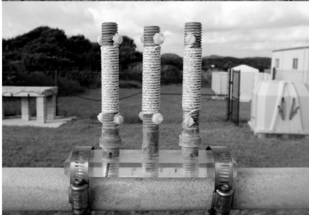
شکل ۲-۳-الف. نمونه های آزمون CLIMAT نصب شده در ایستگاه پایش خوردگی اتمسفری واقع در مرکز فضایی کندی، ۳۰ روز پس از نصب ب. همان نمونه ها پس از ۶۰ روز از نصب [۲].
