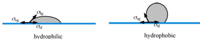
شکل (1-1) تفاوت چسبندگی سطحی دو سطح Hydrophilic و Hydrophobic (Shui et al. 2006)
