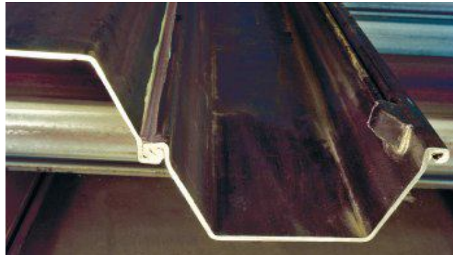
شکل ۲-۳- یک نمونه از اتصال سپرهای فولادی
