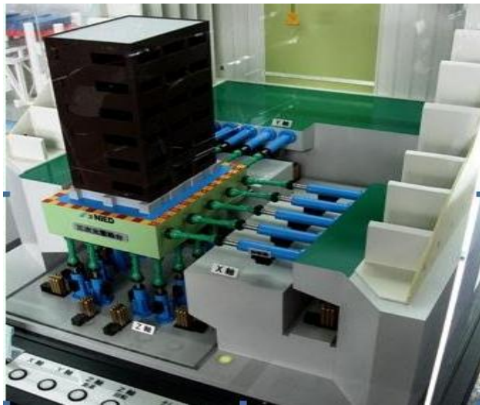
شکل ۲-۷: نمایی از یک میز لرزان با سه درجه آزادی [5]
