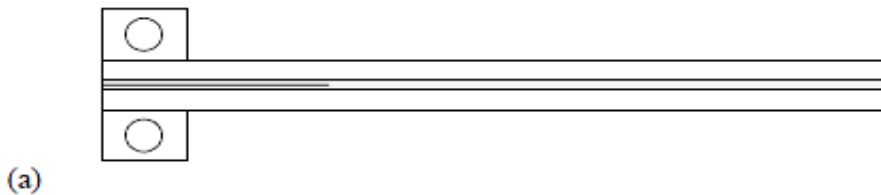
شکل ۱-۴ (الف) - تیر یکسر گیردار مورد استفاده در اتصالات چسبی
