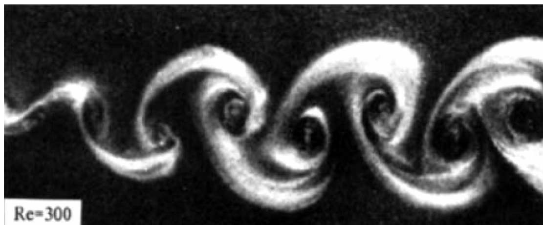
شکل (۱-۳) دنباله گردابه ای فون کارمن که در اثر عبور سیال از روی استوانه ایجاد شده است [2].
