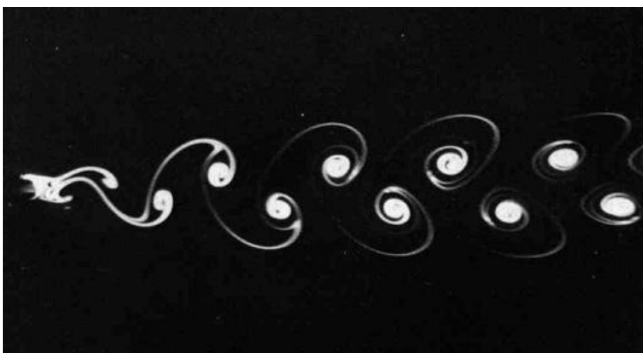
شکل ۱-۳- مسیر گردابه های فون کارمن در پشت استوانه [۵].
