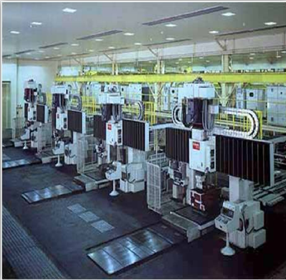
شکل (۱-۱) نمایی از ماشین‌های CNC در یک سیستم تولید انعطاف‌پذیر
