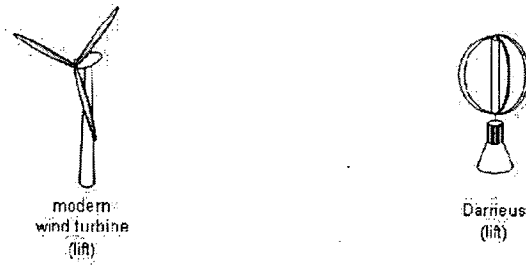
شکل (۳-۲): نمونه از توربین های بادی محور عمودی و محور افقی
