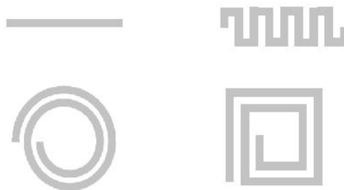
شکل ۱-۴: ساختارهای مختلف مایکرواستریپ برای پیاده سازی یک سلف.
