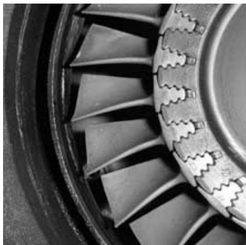
شکل (۱-۲) - نمایشی از چگونگی اتصال پره و دیسک.
