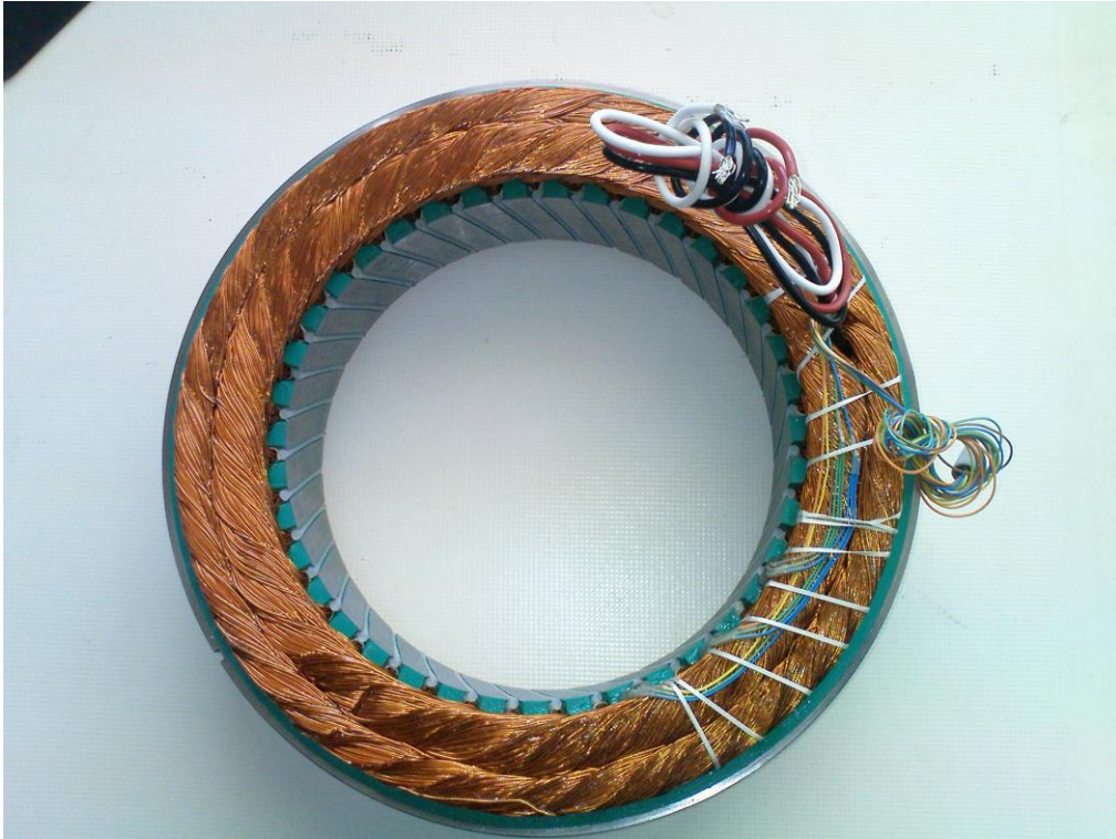
شکل ۲-۳- استاتور یک ماشین BLDC سه فاز
