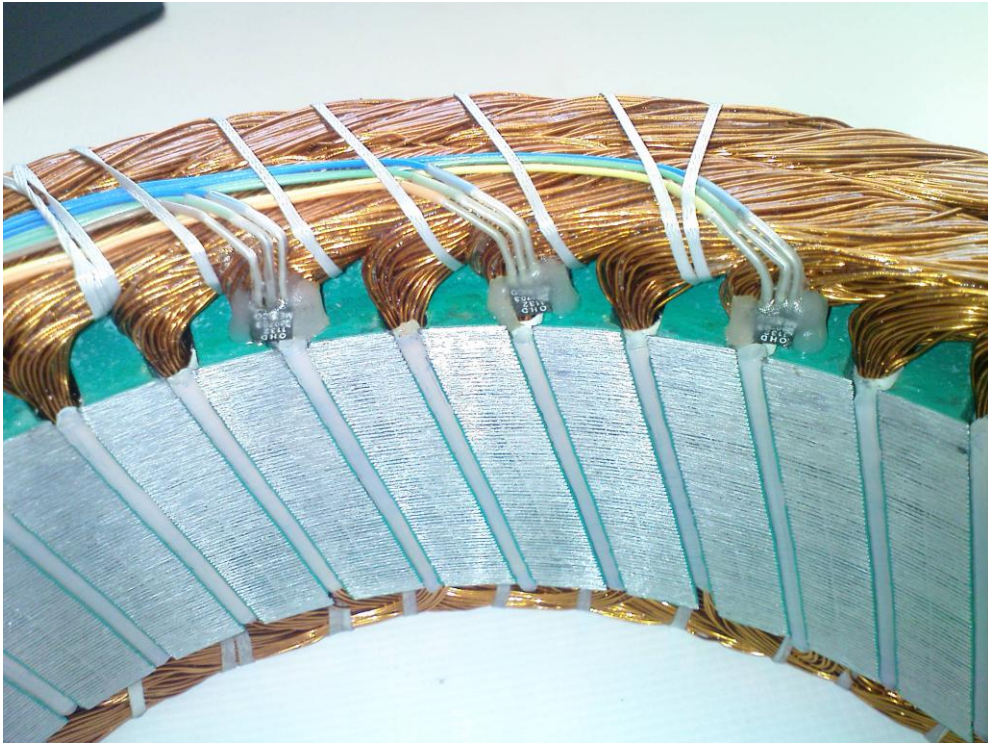
شکل ۲-۴- سنسور های اثر هال بر روی استاتور ماشین BLDC
