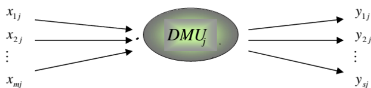
شکل ۱-۲: واحد تصمیم‌گیرنده با m ورودی و s خروجی
