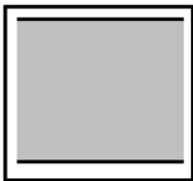
شکل ۱-۳: غشا متراکم غیرمتخلخل (متقارن) [۱].
