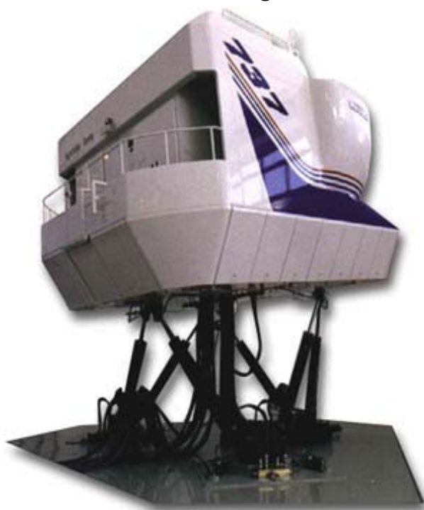
شکل ۴-۱ استفاده ربات استوارت در شبیه ساز پرواز
