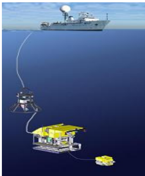
شکل ۳-۱: نمونه‌ای از یک سیستم کامل شناور زیر آبی (ماخذ: www.oceanexplorer.noaa.gov )
