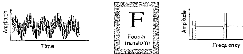
شکل ۱-۱- نمایی از شیوه اثر تبدیل فوریه روی یک سیگنال [۲۵]
