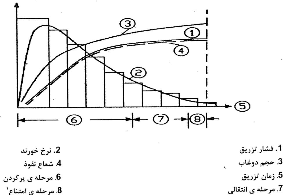
شکل ۱-۱: توصیف شماتیک روند تغییرات پارامترهای کنترلی در تزریق
