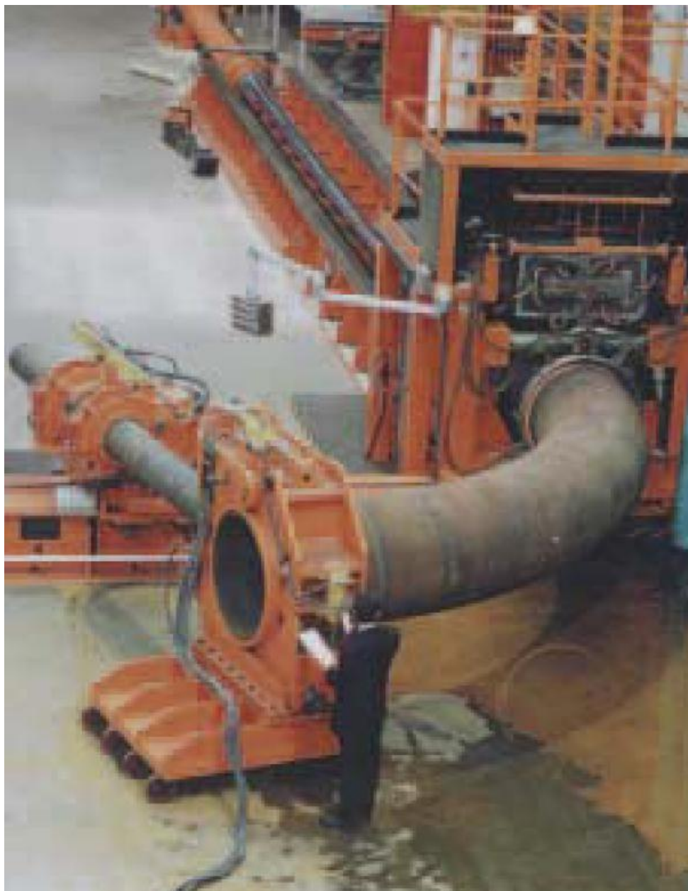
شکل ۲-۲: پروسه خم لوله به روش خمش القایی [۱۲]
